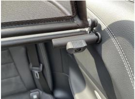
Windschott mit hinteren Haltern einsetzten und Punkte vorne anzeichnen wo Schnellspannverschlüsse ausfahren., noch mal nachmessen und dann mit einem 10,5 mm Bohrer ein Loch vorsichtig bohren eventuell kleiner vorbohren, bitte nicht zu tief nach Möglichkeit nur 10 - 15mm danach mit einem M12 Gewindebohrer ein Gewinde schneiden. Jetzt können sie die mitgelieferte Schraube kürzen um 2/3 Drittel und dann ins Gewinde schrauben.
